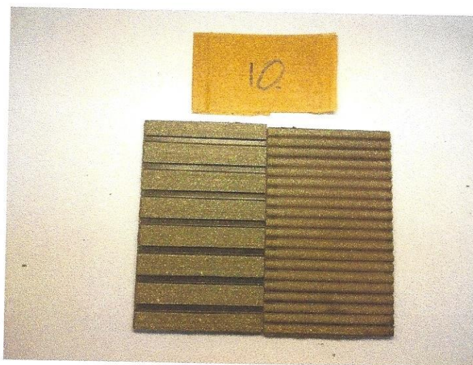
Ekspozīcijas laiks 1000 st reference un paraugs
