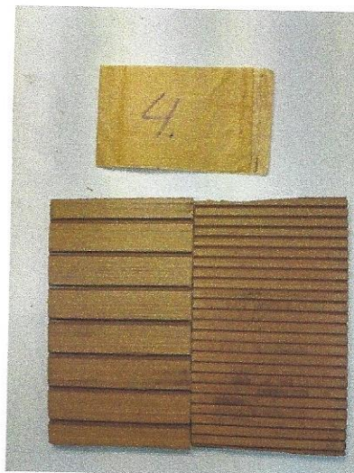
Ekspozīcijas laiks 1500 st reference un paraugs
