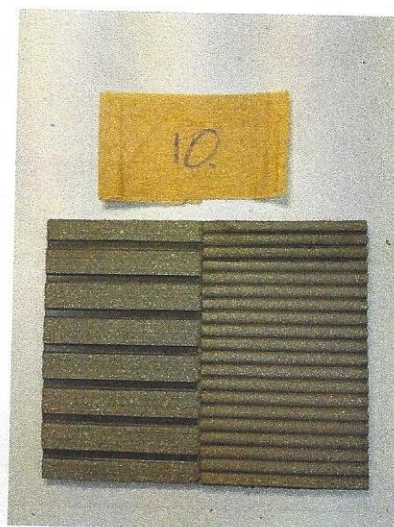
Ekspozīcijas laiks 1500 st reference un paraugs
