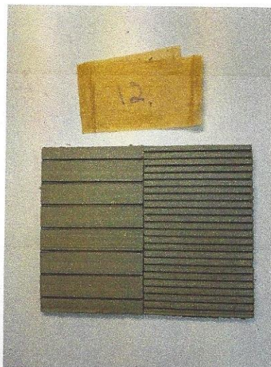
Ekspozīcijas laiks 1500 st reference un paraugs
