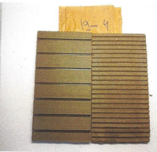
Ekspozīcijas laiks 1500 st reference un paraugs
