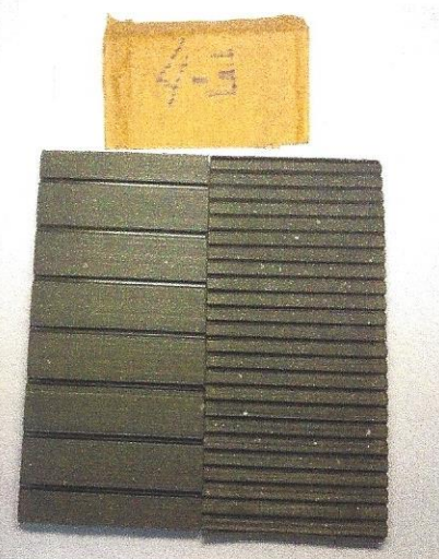
Ekspozīcijas laiks 1500 st reference un paraugs
