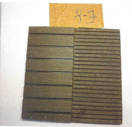
Ekspozīcijas laiks 1500 st reference un paraugs
