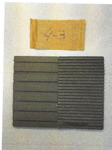
Ekspozīcijas laiks 1500 st reference un paraugs
