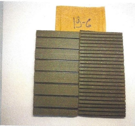
Ekspozīcijas laiks 1500 st reference un paraugs
