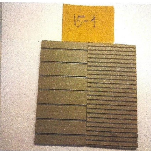
Ekspozīcijas laiks 1500 st reference un paraugs
