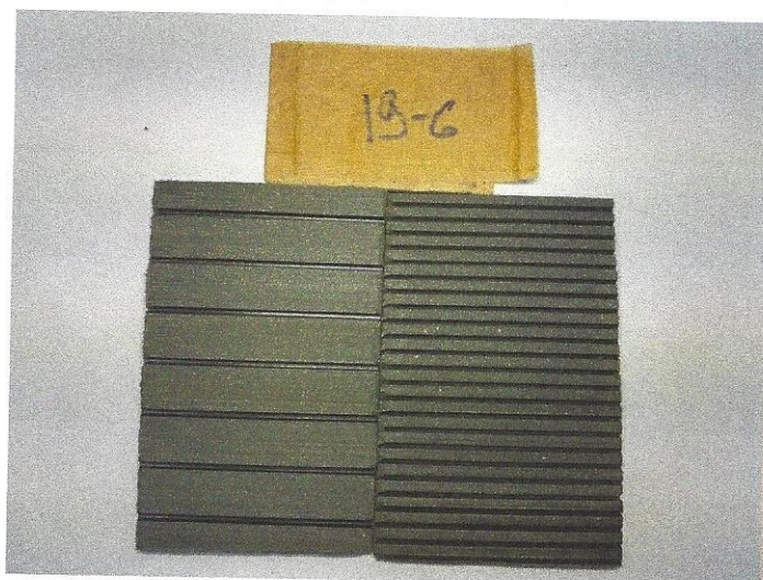
Ekspozīcijas laiks 1000 st reference un paraugs
